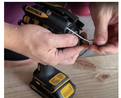
カートリッジから使用したいビットを引き出し通常通り取付け、使用後はビットを取り外せば自動的にビットが収納されます。
