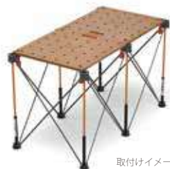
CK22TM Centipede® テーブルトップ 2'x4' ¥14,800 (税込 ¥16,280) ●サイズ: 61×122cm 厚さ: 18mm (2'x4' サイズ) ●材質: MDF ●最大荷重: 2000 lbs. (907kg) ●ドックホール径: 20mm ●ホール間隔: 芯々 96mm ●固定用ツイストロック付属
